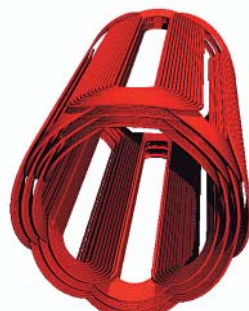
De elektriske ledere, der skal til for at frembringe et oktopol magnetfelt. Inden i denne supraledeende magnet vil antibrint kunne fanges.
